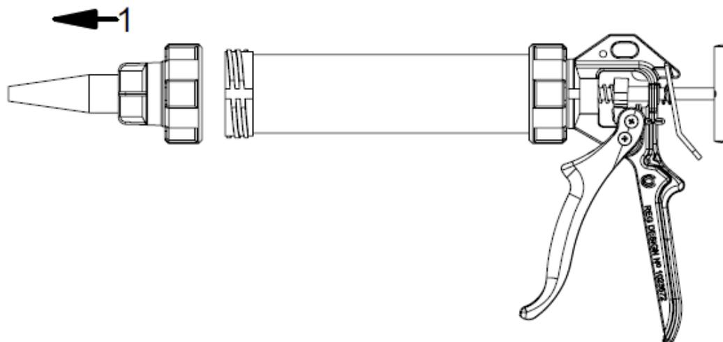
Этим концом пистолет одевается на крышку для заправки герметика
