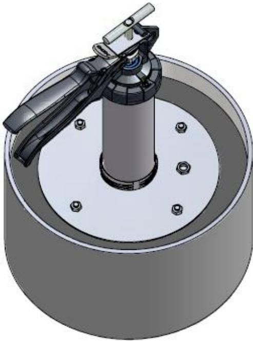
**Вставьте пистолет в отверстие на крышке. Медленно вытаскивайте поршень, одновременно надавливая корпусом пистолета вниз**
