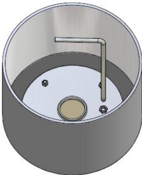
**Как только герметик закончится, верните, поставляемую в комплекте ручку, в гайку на крышке, и вытащите крышку из ведра**
